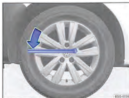
שחרור ברגי גלגל לצורך החלפת גלגל
